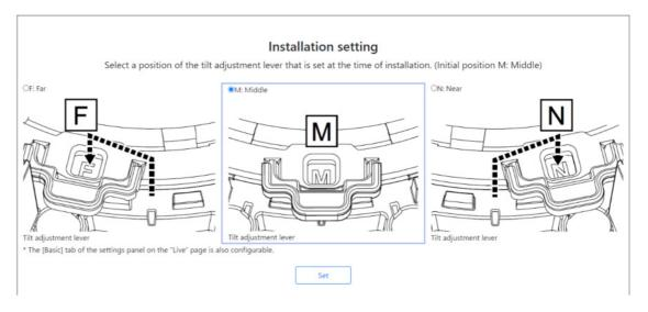
Sélectionnez l'ensemble [Position du levier de réglage d'inclinaison] lorsque les caméras sont installées.
