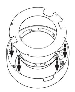
エンクロージャーのマイク 穴と防塵シートの切り欠き 位置を合わせる エンクロージャーのリブに 防塵シートのスリットを差 し込む
