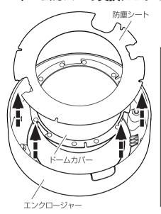
エンクロージャーの爪のうちの 2か所を、エンクロージャーを 外側に広げるようにして1か所 ずつ外す。
