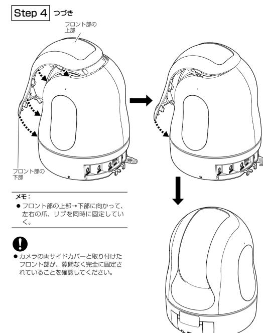
以降の取り付け作業は、ドームカバー部分に保護シートを付けた状態で実施 してください。
