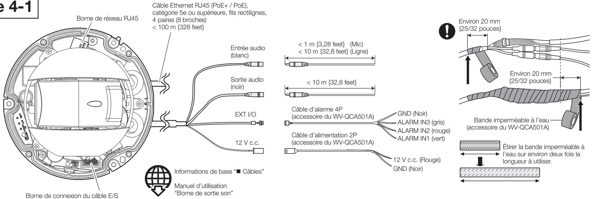
■ Lors de la connexion du câble Ethernet RJ45 (à se procurer localement) directement à la caméra video.
