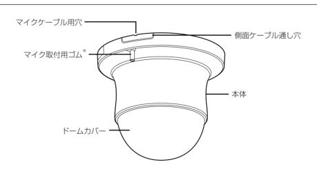
※タイピン型マイクを使用するときは、マイク取付用ゴムにマイクを取り付けてください。 使用しないときは、マイク取付用ゴムをニッパーで切るなどの処理をしてください。
