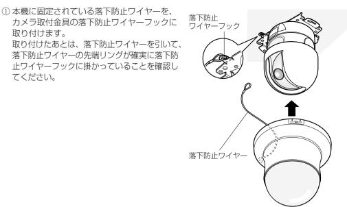
② 本機の「OPEN」マーク(2か所)をカメラ取 付金具の凸部(2か所)に合わせて取り付けま
