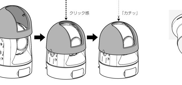
■インナーカバーを取り外す場合 左右の内側の爪を片方ずつ外してインナーカバーを取り外す。
