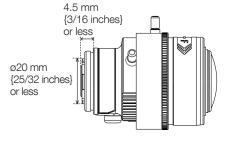
\* La longueur de la vis est un exemple lors de l'installation de la caméra, au plafond
