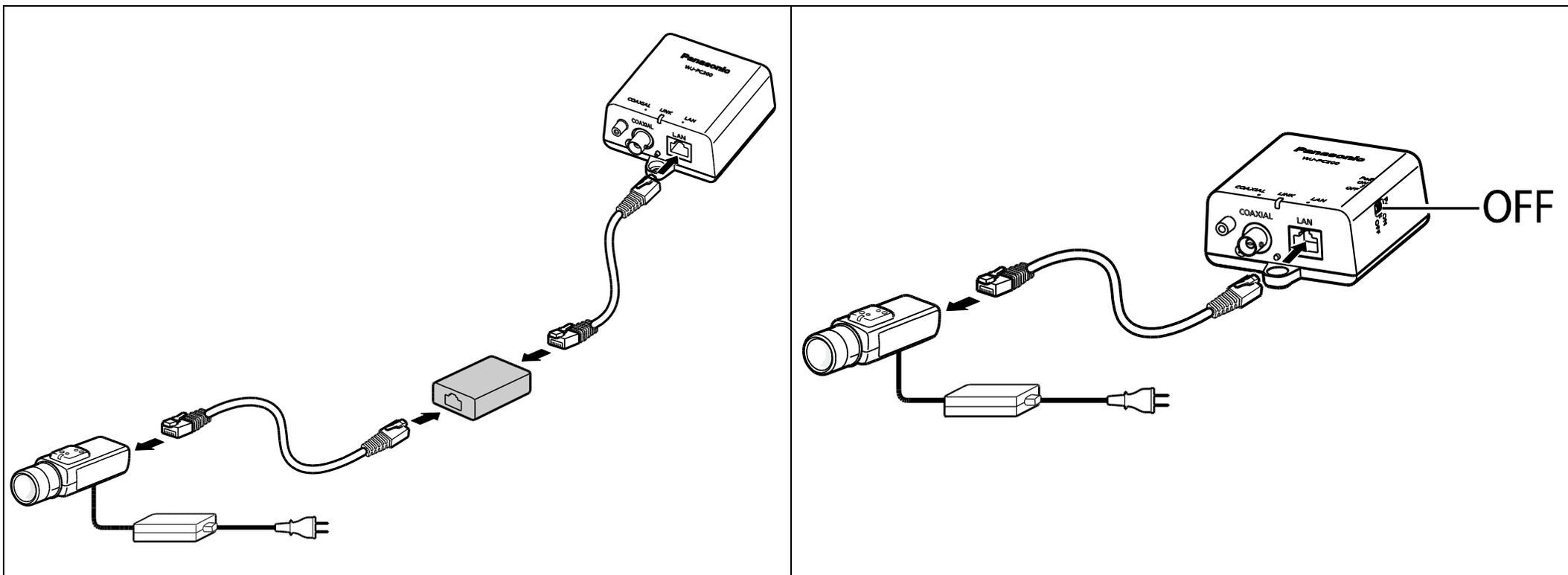
**4.2 Conexões (1. Conecte um cabo de Ethernet (Cat-5e ou superior) à unidade do lado da câmera e à câmera de rede.)**
