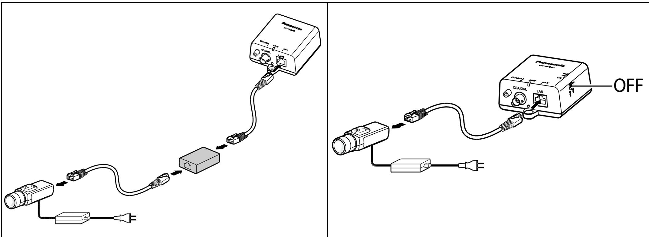
**4.2 Anschlüsse (1. Schließen Sie ein Ethernetkabel (Cat-5e oder höher) an die Kameraeinheit und die Netzwerk-Kamera an.)**
