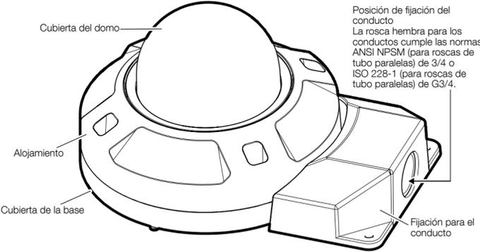
Posición de fijación del conducto
