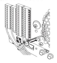
③拉紧电缆夹(附件)的电缆扎带,并将其固定在右上方。
