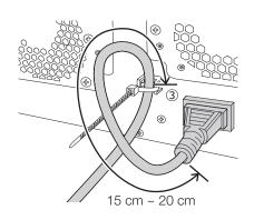
③在距离插头15至20厘米处束紧电源线,并将其固定到 电源线夹座。
