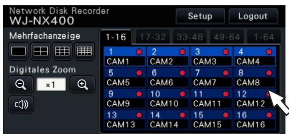
Zum Bedienen des Rekorders den auf dem Hauptmonitor angezeigten Mauscursor mit der an den Rekorder angeschlossenen Maus bewegen und die auf dem Bildschirm erscheinenden Tasten und Register mit der linken Maustaste anklicken. (Nachfolgend wird "Linksklick..." in diesem Dokument einfach mit "Klick..." bezeichnet.)
