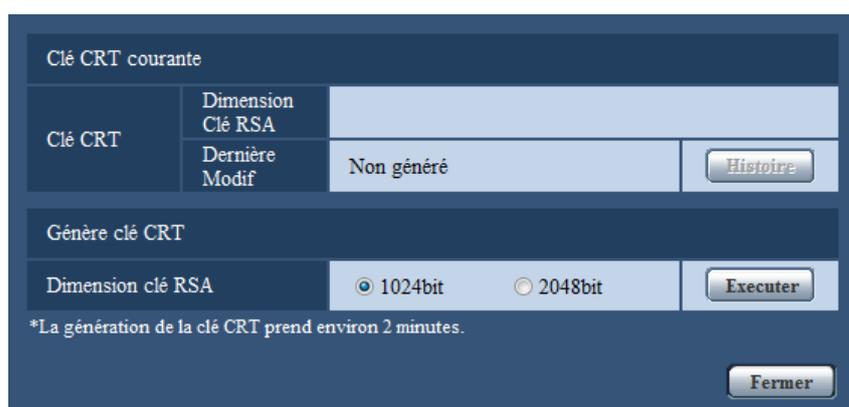
2. Sélectionner "1024bit" ou "2048bit" comme longueur de clé CRT pour la générer pour "Génère clé CRT" - "Dimension clé RSA".
